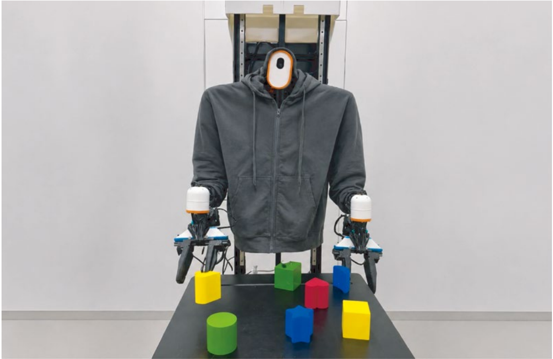
로봇 GARO의 4월자 기준 형태. 21 자유도(양 팔 관절, 양 손 그리퍼, 본체 바퀴 2개, 수직 승강레일), 카메라 3개로 구성됩니다.
